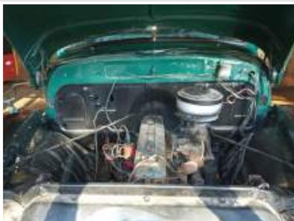
**Foto 3.** Troca do motor de 6 cilindros para 12
